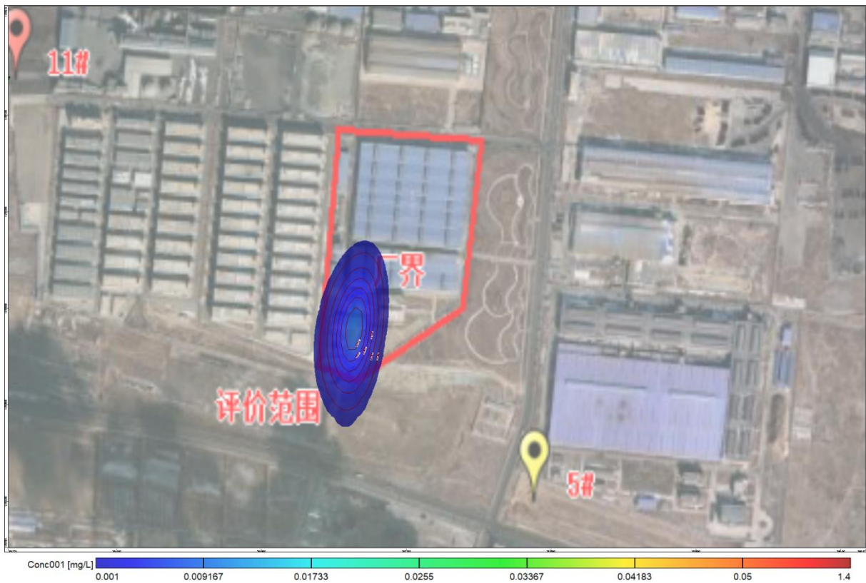
图 9.3-22 石油类泄漏 3 天，第 365 天污染扩散图
