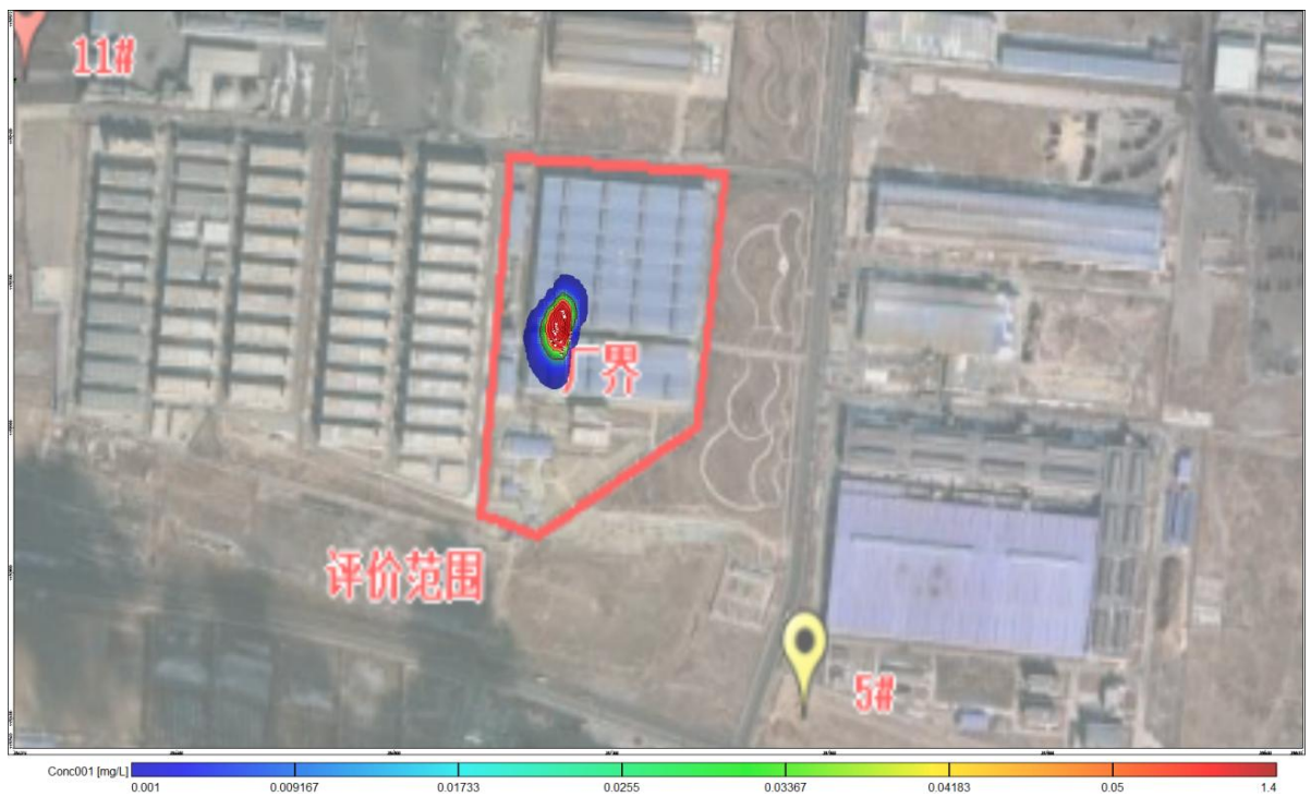
图 9.3-20 石油类泄漏 3 天，第 30 天污染扩散图
