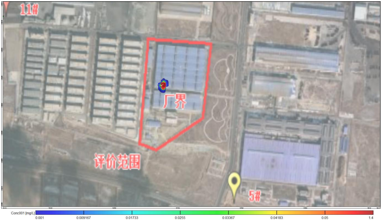
图 9.3-19 石油类泄漏 3 天污染扩散图
