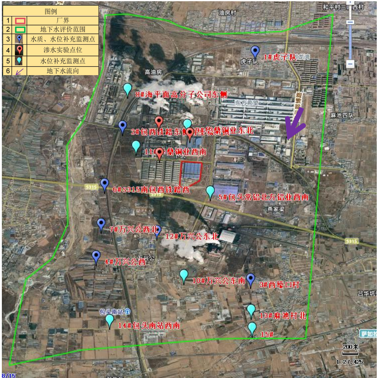
图 7.2-1 本项目地下水监测点位分布图
