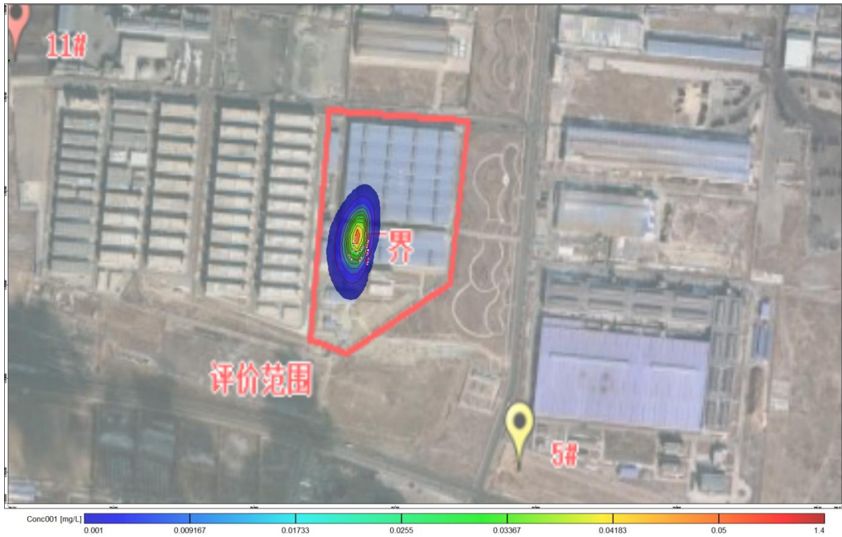
图 9.3-21 石油类泄漏 3 天，第 100 天污染扩散图
