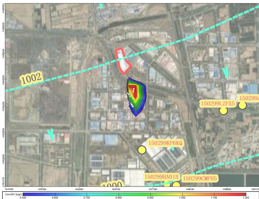
图 9.2-10 废水渗漏 365 天后第 1000 天 TDS 运移情况
