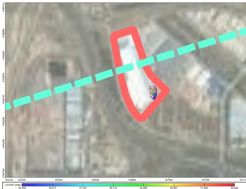
图 9.2-8 废水渗漏 365 天后第 100 天 TDS 运移情况
